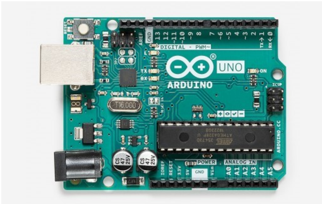
Figure 1, de Arduino Uno is een goedkope microcontroller waarmee je zelf apparaatjes kunt bouwen, zoals digitale thermometers of een robot.
