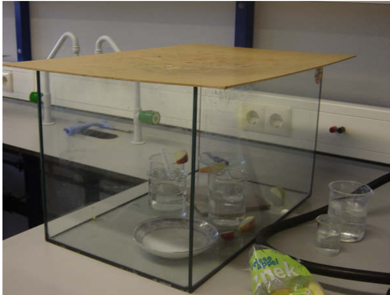
Figuur 2: Opstelling om vingerafdrukken zichtbaar te maken met behulp van de cyanoacrylaatmethode (foto met toestemming van Jord Betjes en René Oud).
