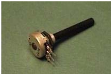
Figuur 3a: Potentiometer met drie aansluitpunten
